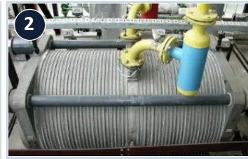
SZEU-20 electrolyser cell stack
