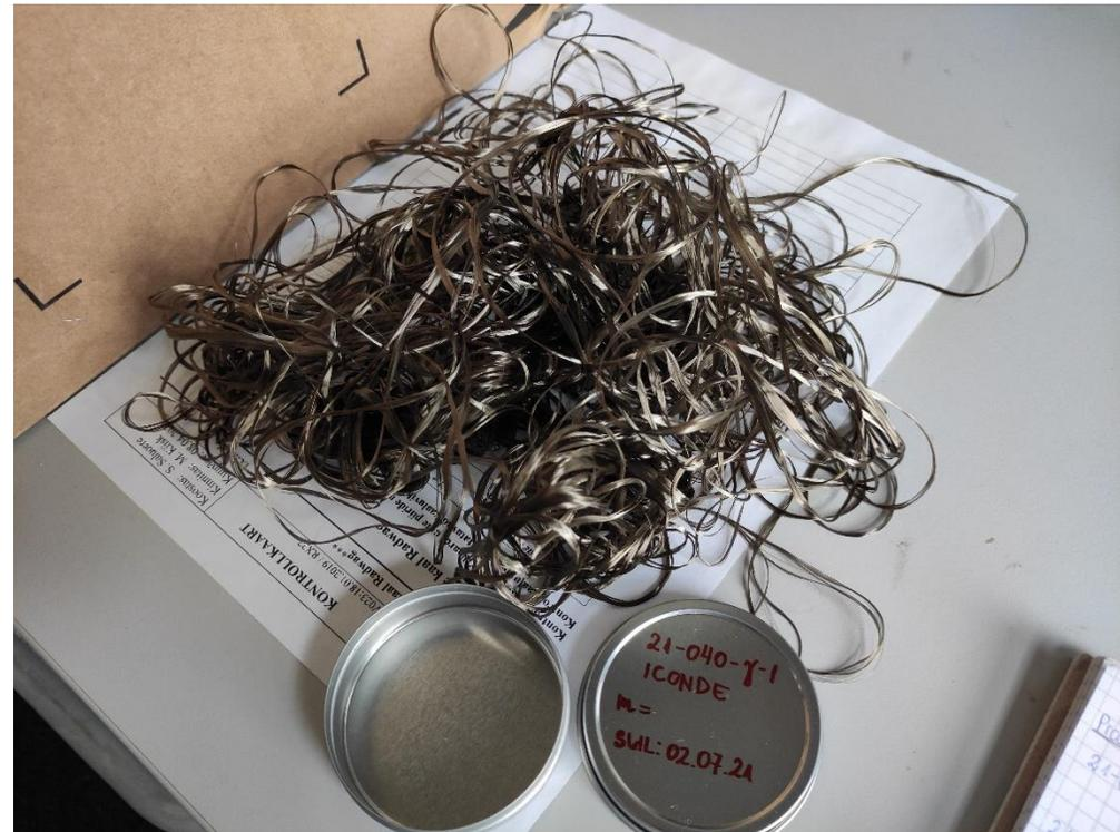
Fig.: Basalt fiber
